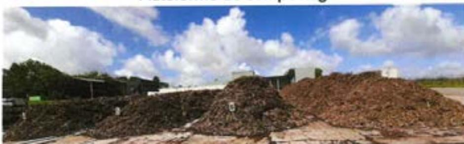
La plateforme de compostage située au quai de transfert permet le traitement d'une partie des déchets verts qui sont par la suite broyés, criblés puis mis en andains jusqu'à maturation, afin de produire un compost conforme à la norme NFU 44-051. Ce compost est ensuite mis à disposition gratuitement dans les 6 déchèteries, pour tous les usagers particuliers. En 2021, une partie des déchets verts a été traitée sur le site de Paprec Agro.
