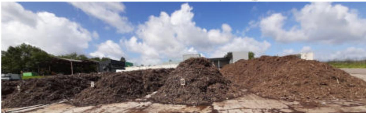
La plateforme de compostage située au quai de transfert permet le traitement d'une partie des déchets verts qui est par la suite broyée, criblée puis mise en andains jusqu'à maturation, afin de produire un compost conforme à la norme NFU 44-051. Ce compost est ensuite mis à disposition gracieusement dans les 6 déchèteries, pour tous les usagers particuliers. En 2020, une partie des déchets verts a été traitée sur le site de Paprec Agro.
